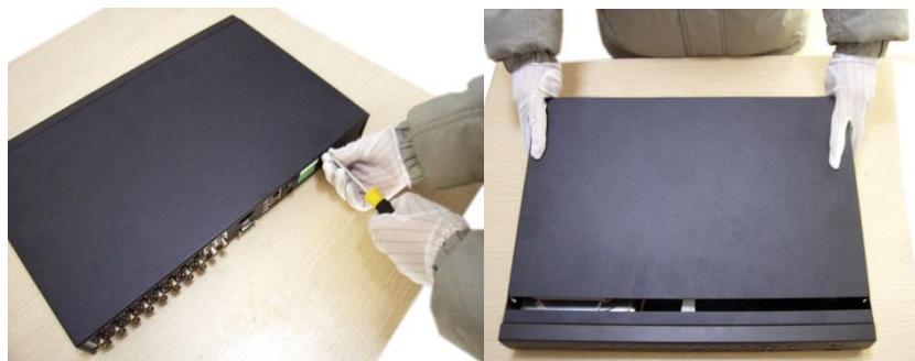
Открутите шурупы и снимите верхнюю крышку устройства
