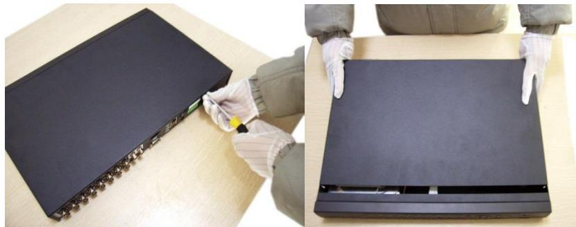
Открутите шурупы и снимите верхнюю крышку устройства
